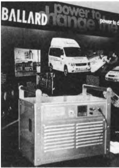
Brennstoffzelle von Ballard Power Systems für den Einsatz in Null-Emissions-Fahrzeugen von DaimlerChrysler
