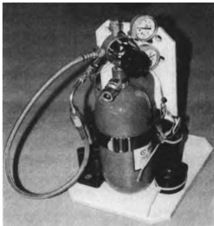
Umrüstsatz zur Nutzung von Fahrzeugmotoren mit Wasserstoff
