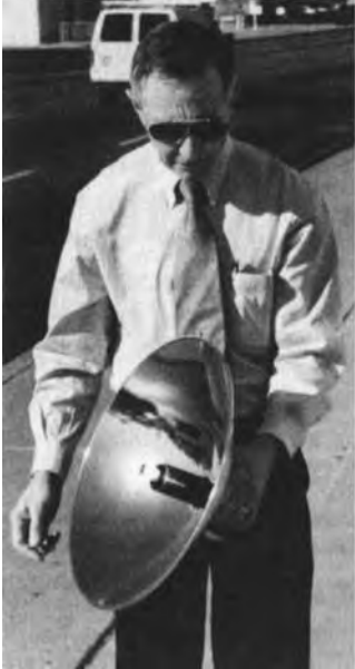
Roy McAlisters Sonnenschüssel-Generatormodul: Sonnensollektor (links) und Stirling-Motor (oben)
